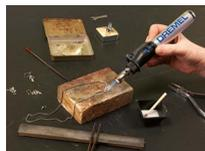
Le mécanisme de blocage de la flamme permet de garder le fer à souder à une température constante.
