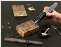
Le mécanisme de blocage de la flamme permet de garder le fer à souder à une température constante.
