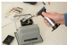
Flacără arzătorului cu gaz butan permite lucrul în detaliu cu flacără deschisă
