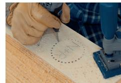
Струбцину можно использовать как вместе с базовой опорой, так и отдельно.
